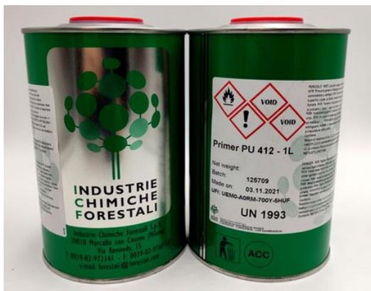
*Ha un tempo di asciugatura minimo di 15 minuti e massimo di 24 ore, che si riduce a un'ora se aggiungiamo attivatore RFE in ragione del 1-2% in peso. Da utilizzare esclusivamente con colle poliuretatiche.*
